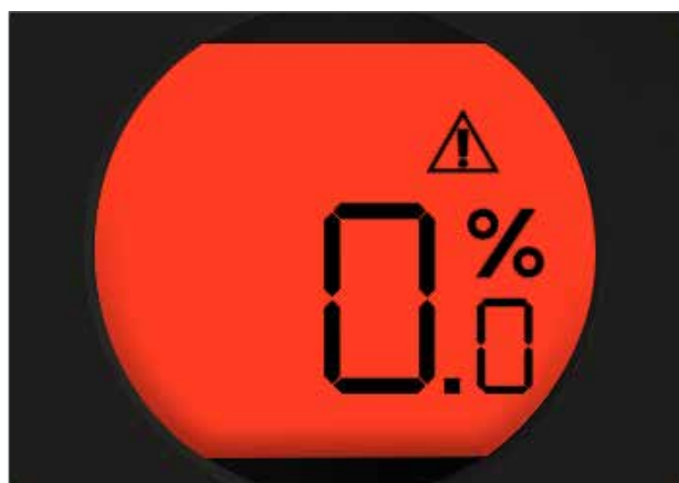
Рис. 9.3 Дисплей привода попеременно мигает красным и белым когда работает БРП при сбое питания.
