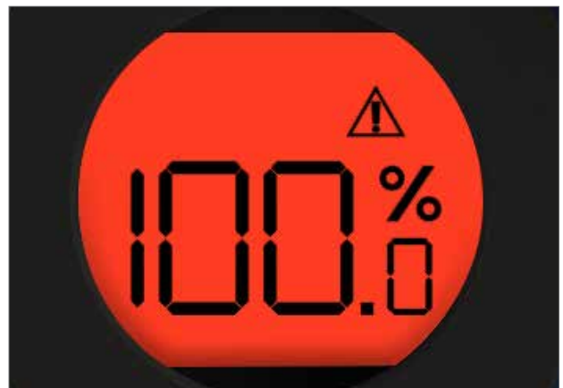
Рис. 5.7 Привод попеременно мигает красным и белым при сбое питания
