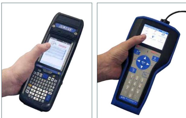
Abbildung 1. Links: ECOM, rechts: Rosemount 475. Der CVA kann mit einem Wireless-fähigen Bluetooth-Gerät, wie z. B. einem PC, konfiguriert werden. Wahlweise kann auch ein handelsüblicher HART-Kommunikator, wie z. B. ECOM oder Rosemount 475, verwendet werden. Rosemount 475, eingesetzt werden.
