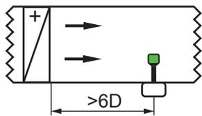
Den Fühler an einer Stelle mit laminarer (nicht turbulenter) Strömung positionieren. Turbulente Strömungen entstehen nach Rohrkrümmungen, Abzweigungen, hinter Klappen, Ventilatoren, Lufterwärmer, Luftkühler, Filter oder Querschnittsveränderungen.
