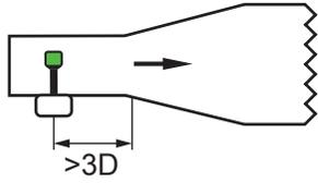
Fühler vor Diffusor, an einem Ort mit hoher Strömungsgeschwindigkeit positionieren.
