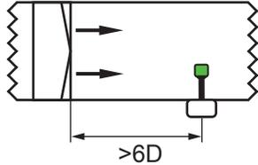
Optimal ist eine Position nach einem Filter.
