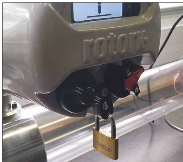
Рис. 7.2. Селектор управления IQ3 заперт на висячий замок в "Дистанционное"
