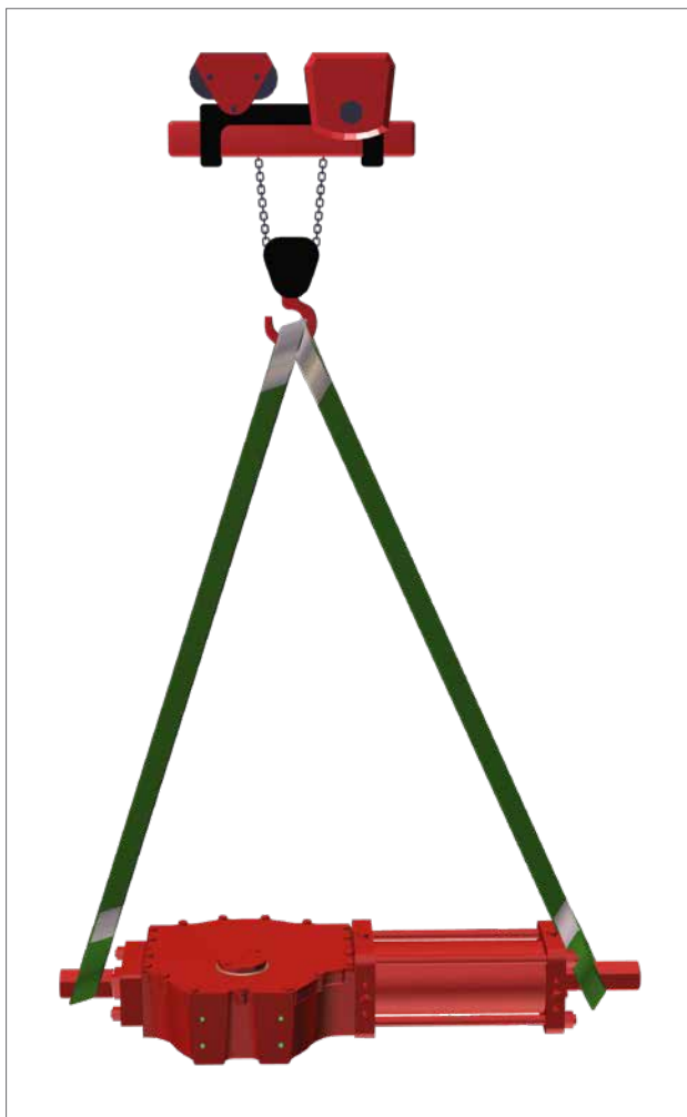
Fig 7.2 Løft (dobbeltvirkende aktuator op til størrelse 161)
