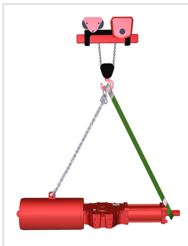
Fig 7.1 Løft (enkeltvirkende aktuator op til størrelse 161)
