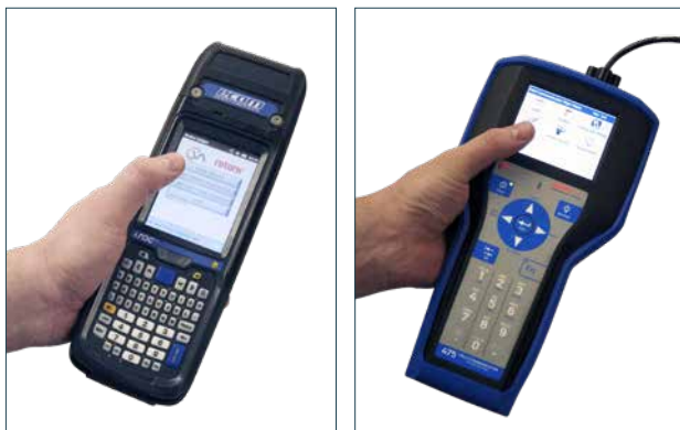
Figura 1 Sinistra: ECOM, destra: Rosemount 475. CVA può essere configurato utilizzando un dispositivo abilitato Bluetooth wireless come un PC o, in alternativa, un comunicatore HART classico, come ECOM o Rosemount 475
